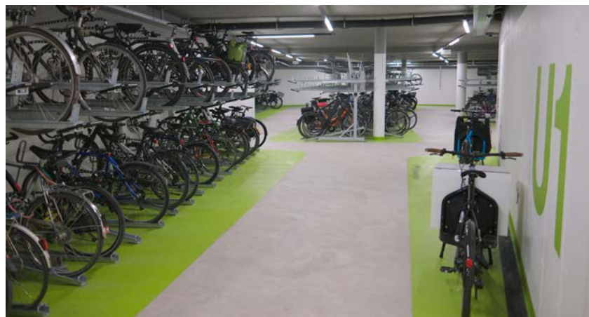
Doppelstockparker, ermöglichen eine gute Ausnutzung des Raums.
