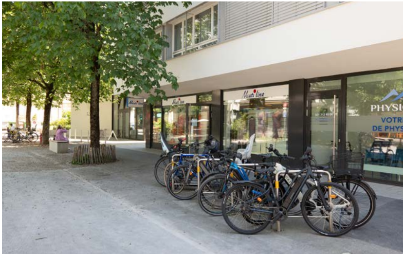
Veloparkierung im Strassenraum: Anlehnbügel verhindern Diebstahl und Kippen
